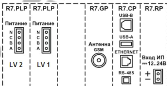
Рисунок 7.2 - Панель разъемов УСПД
