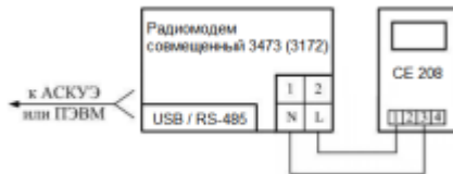
Рисунок 13 Схема подключения счетчика через PLC-интерфейс
