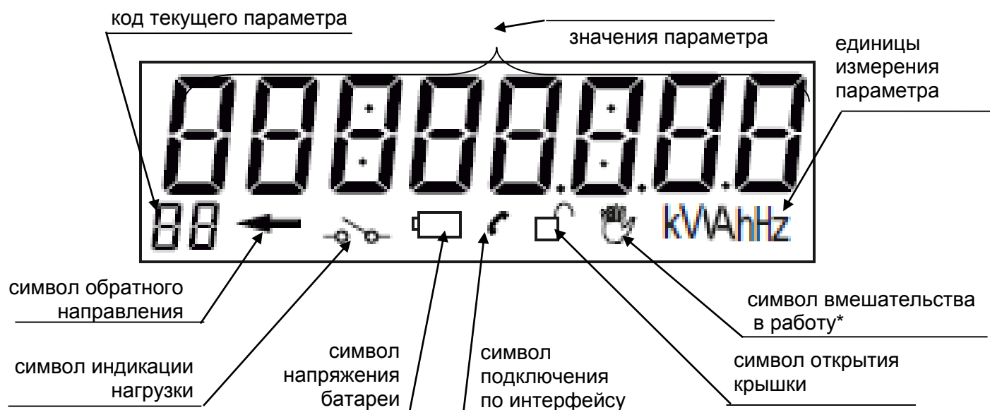
Рисунок 3.1 – Внешний вид дисплея счетчиков модификации со всеми включенными сегментами
